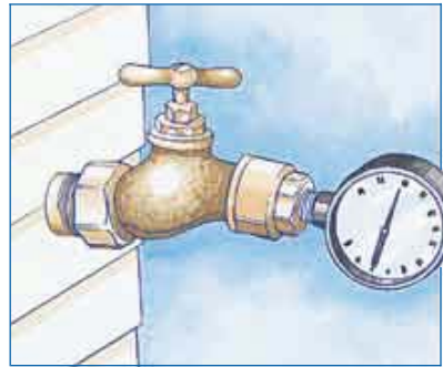
Um den Wasserdruck zu prüfen, befestigen Sie einen Druckmesser an dem Außenwasserhahn, der sich am dichtesten an der Wasseruhr bzw. Wasserquelle befindet. Druckmesser sind bei Ihrem örtlichen Hunter-Lieferanten erhältlich.
