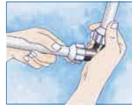
2. Schieben Sie das Rohrende bis zum Anschlag in das Anschlussstück, und ziehen Sie die Überwurfmutter über das Rohr.
