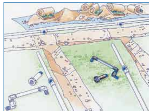
Legen Sie die Rohre und Regner neben den Gräben aus, in die sie eingebaut werden sollen.
